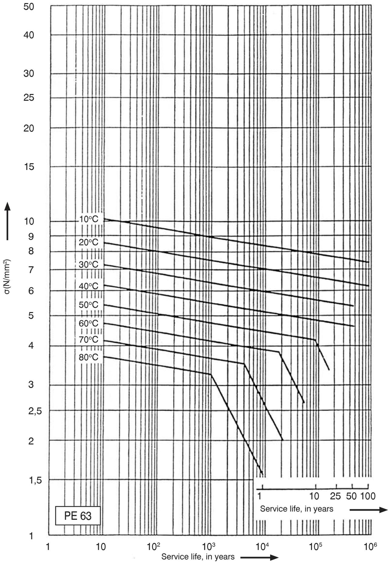
ALLOWABLE OPERATING PRESSURE FOR PIPES
